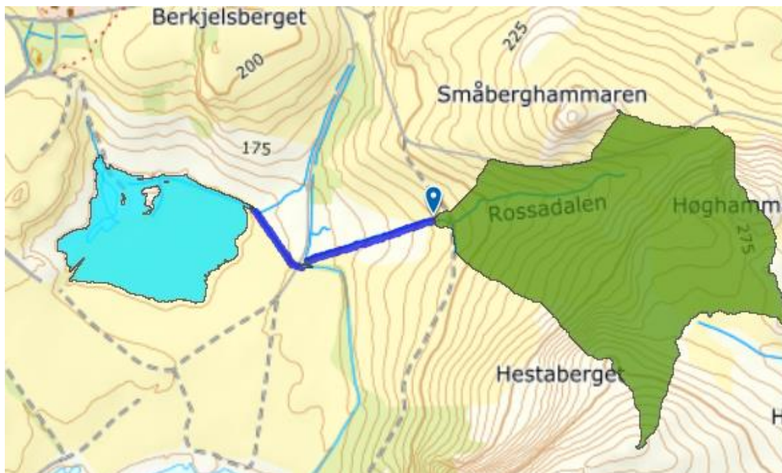
Figur 2 Tilsig fra Rossadalen. Den grønne representerer nedbørsfeltet til bekken som planlegges avskjært med en ny grøft
