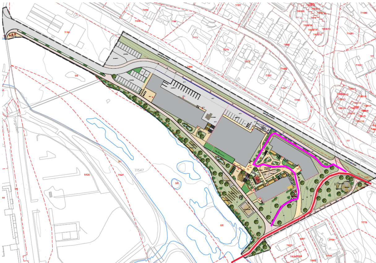
Utsnitt av illustrasjonsplanen – ny hovedtrase gang- og sykkelvei er vist med rød linje. Universelt utformet gangvei er vist med rosa linje
