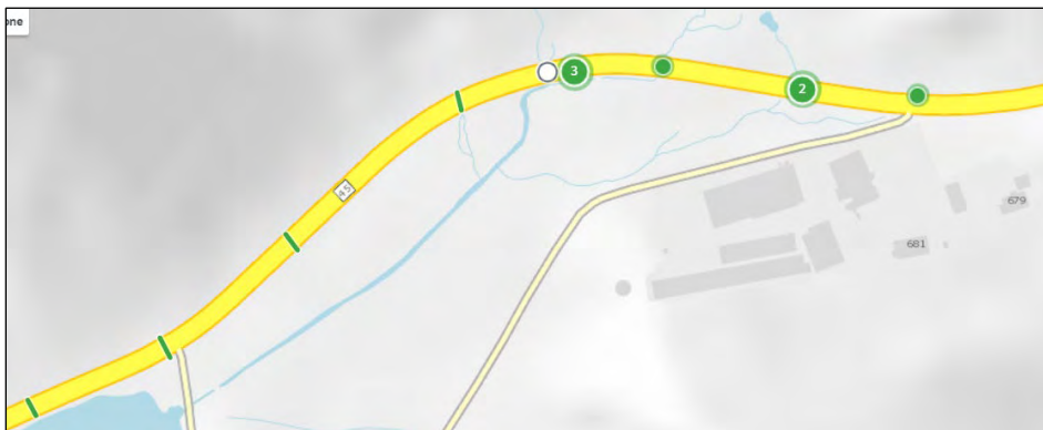
Figur 10: Hvit prikk angir plassering for 1200mm betongrør. Kilde: Vegkart
