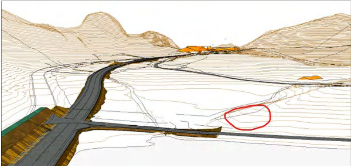
Figur 38: Utklipp fra modell med eksisterende og ny veg, samt avkjørsel. Plassering av skytterstillinger markert med rødt.
