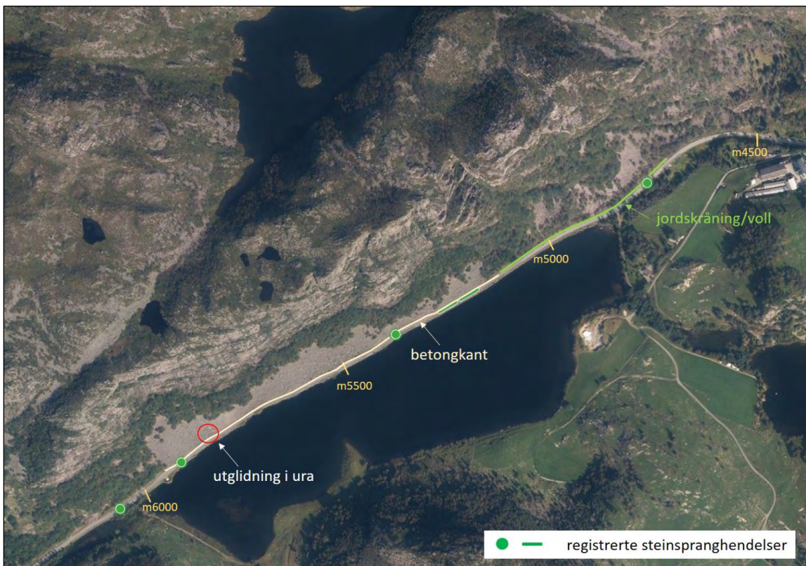
Figur 8: Ortofoto fra 2019 over Bergsura og Nedre Bergsvatnet, med registrerte skredhendelser og tidligere tiltak (betongkant og jordkant).
