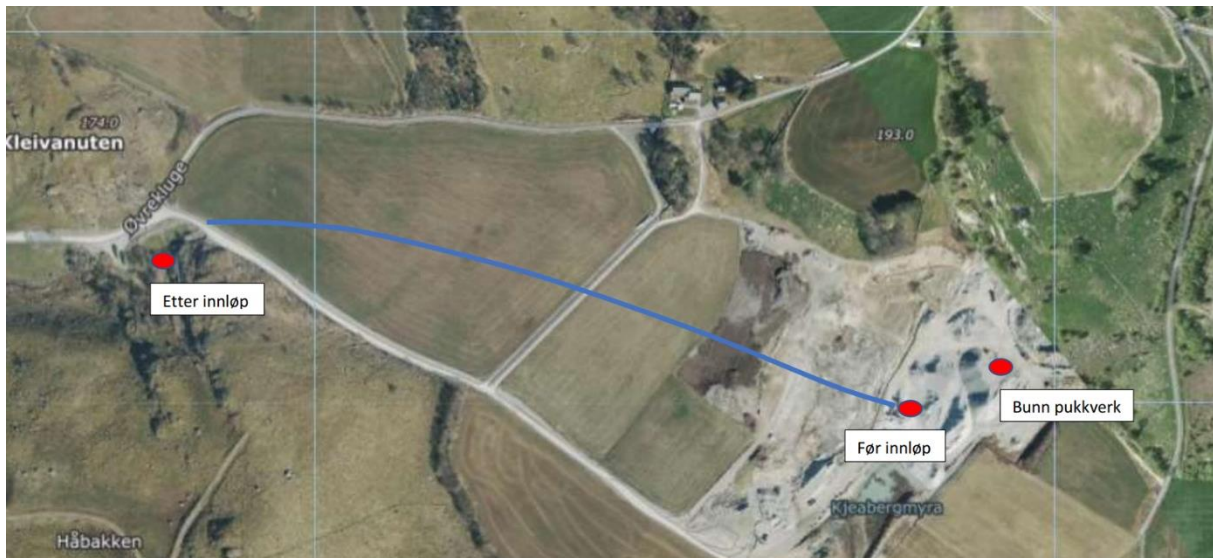
Figur 11.2: Overvannsrør fra planområdet til Kleivabekken i vest.
