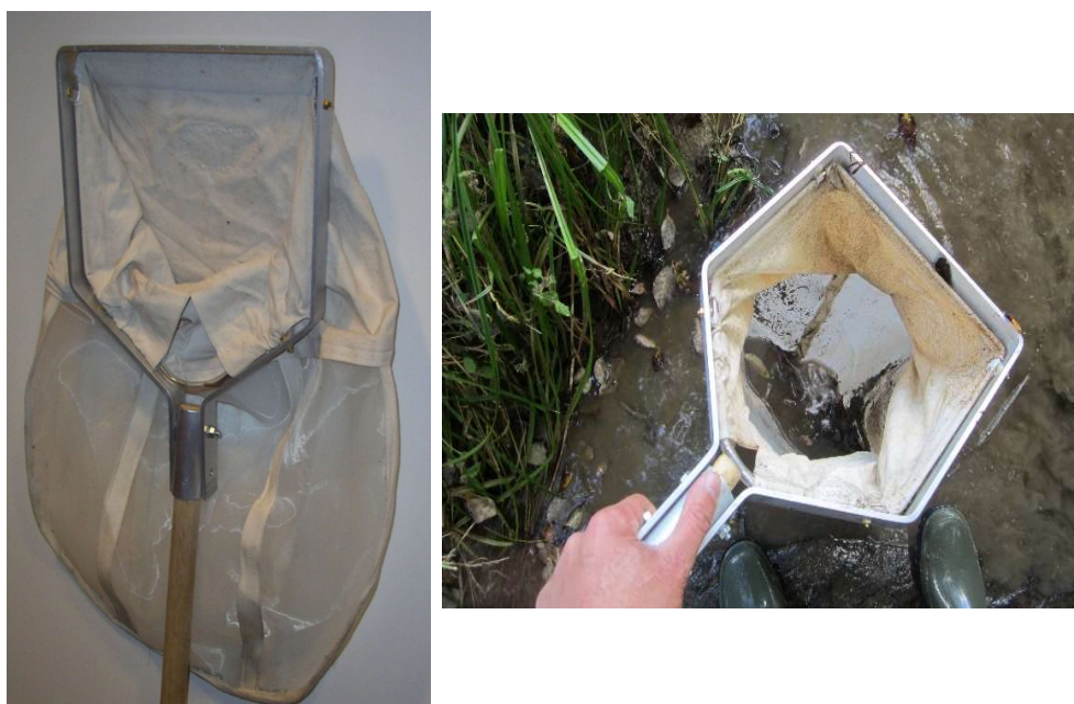
Figur 9. Standardisert håv med tverrsnitt 25*25 cm og maskevidde 250 µm.
